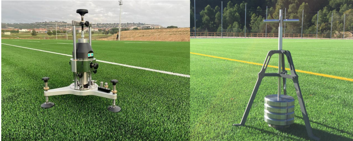
Figura 6. Herramientas de evaluación del césped artificial (Triple A y Rotacional)
