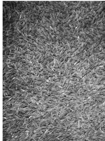
Superficie tras 12 meses cepillado mínimo pelo inclinado
